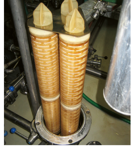
Abb. 3: Schmutz- und Eisenbelag auf Filterkerzen
